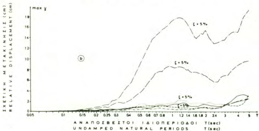
Σχ 3 ΘΑΣΙΜΑ ΑΠΟΚΡΙΣΕΩΣ ΜΕΤΑΚΙΝΗΣΕΩΝ ΕΛΛΗΝΙΚΩΝ ΣΕΙΣΜΩΝ FIG.3 DISPLACEMENT RESPONSE SPECTRA OF GREEK SHOCKS
