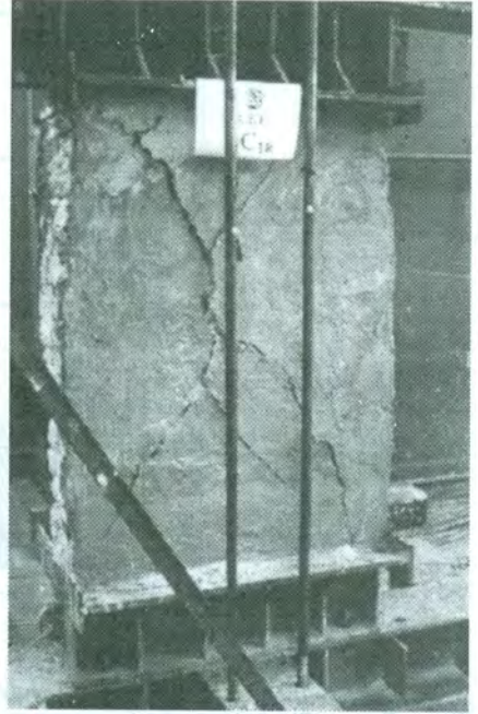
Σχήμα 9. Ρηγματωμένο δοκίμιο CR1 Figure 9. Crack pattern of specimen CR1
