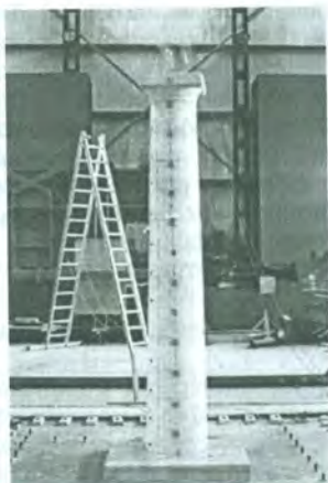
Σχήμα 2. Φωτογραφία και διάταξη σύνδεσης βελομέτρων του πειραματικού μοντέλου του κίονα. Figure 2. Photograph and displacement transducers setup of the multi-block column model.
