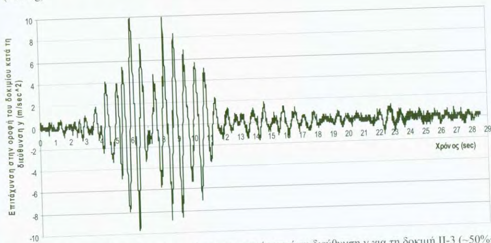
Σχήμα 17. Δοκίμο II: Χρονοϊστορία επιτάχυνσης σεισμικής τράπεζας κατά τη διεύθυνση γ για τη δοκιμή II-3 (~50%g)
