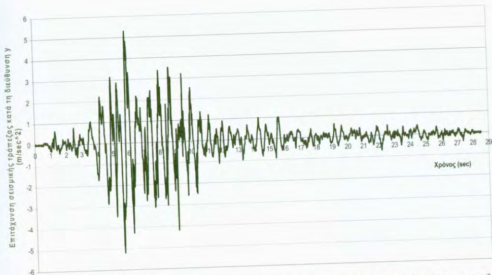
Σχήμα 17. Δοκίμο II: Χρονοϊστορία επιτάχυνσης σεισμικής τράπεζας κατά τη διεύθυνση γ για τη δοκιμή II-3 (~50%g)
